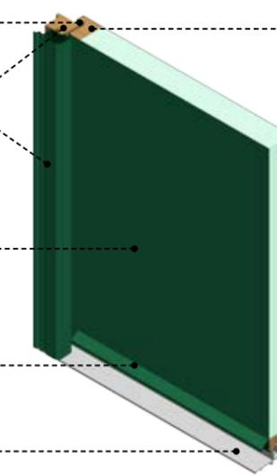
Cadre bois exotique lamellé collé non apparent
