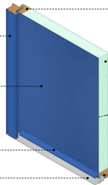
Cadre bois exotique lamellé collé non apparent
