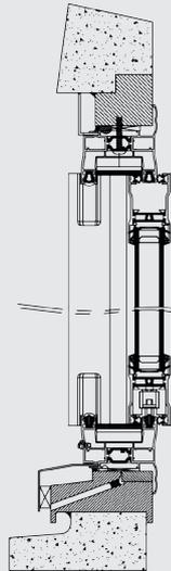
Ailette rénovation de 17 mm sur dormant rénovation (possibilité dormant standard avec couvre-joint de 25 à 50 mm)
